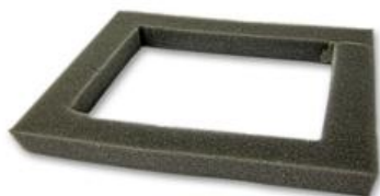
Exemplo de Calço de Espuma T-20 CALCO DE ESPUMA VAZADO(220X170X30X20 MM) DENSIDADE 30KG/M3
