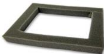
Exemplo de Calço de Espuma T-20 CALÇO DE ESPUMA VAZADO(220X170X30X20 MM) DENSIDADE 30KG/M3
