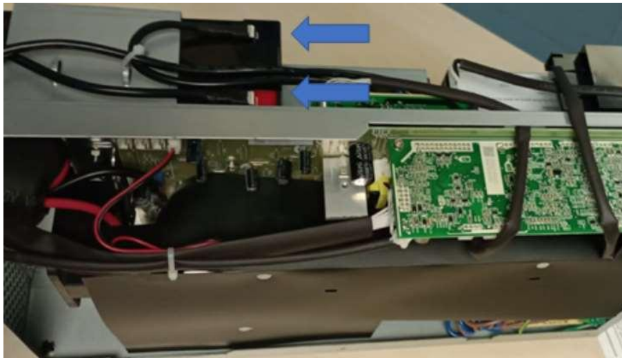
Figura 9: Realizar a medição com o multímetro nos bornes indicados.
