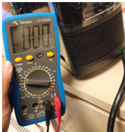
Figura 2: Medição realizada na tomada de saída do equipamento, com o nobreak completamente desligado e desplugado da tomada de energia
