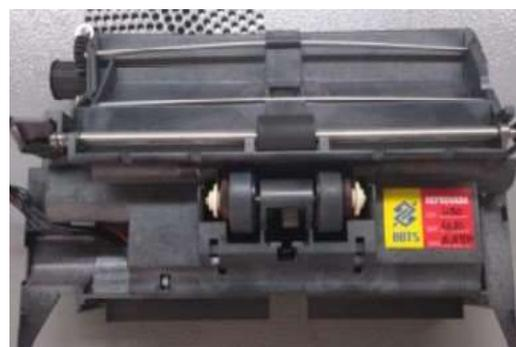
Figura 6 - Peça identificada com etiqueta de reprovação
