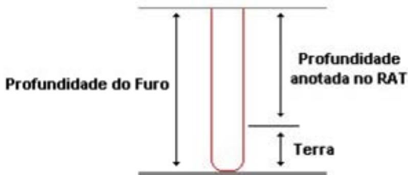
2.6. Encerrar o procedimento de teste de verificação caso não encontre terra, e iniciar o procedimento de fixação do TAA / REICLADOR no solo. Após o término do procedimento de teste do piso, anotar a profundidade encontrada de material duro (*Piso, Contrapiso, Argamassa e Concreto*) no RAT; este valor deve ser maior ou igual a 130mm.
