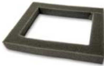
Exemplo de Calço de Espuma T-20 CALÇO DE ESPUMA VAZADO(220X170X30X20 MM) DENSIDADE 30KG/M3
