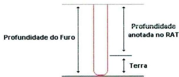
2.5. Encerrar o procedimento de teste de verificação caso não encontre terra, e iniciar o procedimento de fixação do TAA / RECICLADOR no solo. Após o término do procedimento de teste do piso, anotar a profundidade encontrada de material duro (*Piso, Contrapisc, Argamassa e Concreto*) no RAT; este valor deve ser maior ou igual a 130mm.
