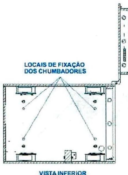
2.8. Retirar o gabarito ou afastar o TAA / RECICLADOR e realizar os furos perpendiculares ao piso (ângulo de 90°) utilizando a broca de aço viede longa de 20 mm até a profundidade de 150 mm.
